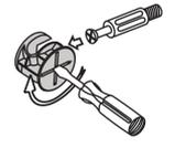
The head of the mini fix housing goes into the open mouth of the mini fix bolt. You then turn the mini fix housing so it tightens over the mini fix bolt.
