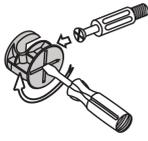
The head of the mini fix housing goes into the open mouth of the mini fix bolt. You then turn the mini fix housing so it tightens over the mini fix bolt.
